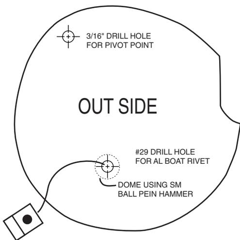
Fig. 4 This is the Air Baffle at 50% <AIR BAF-FLE.2.EPS>
